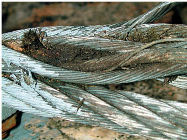
Fig. 24 - Exemple de câble à âme textile (AT) avec âme fortement dégradée.
