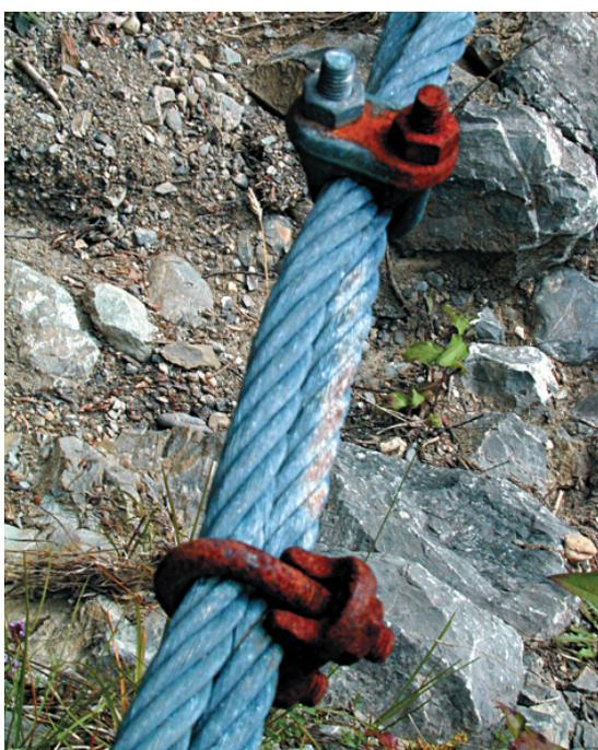
Fig. 7 - Corrosion de serre-câbles avec divers degrés d'atteinte consécutifs à une hétérogénéité de la galvanisation.
