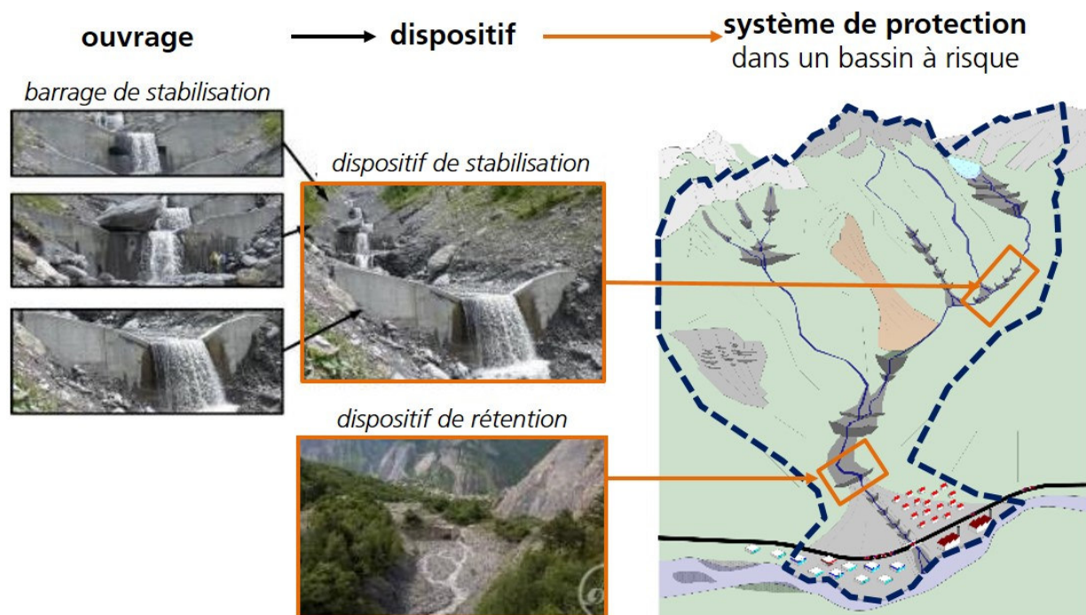
Figure 3 – Echelles de mesures de protection torrentielle
