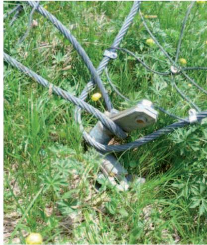
Cliché 19 : rupture de la pièce de liaison ancrage-filet
