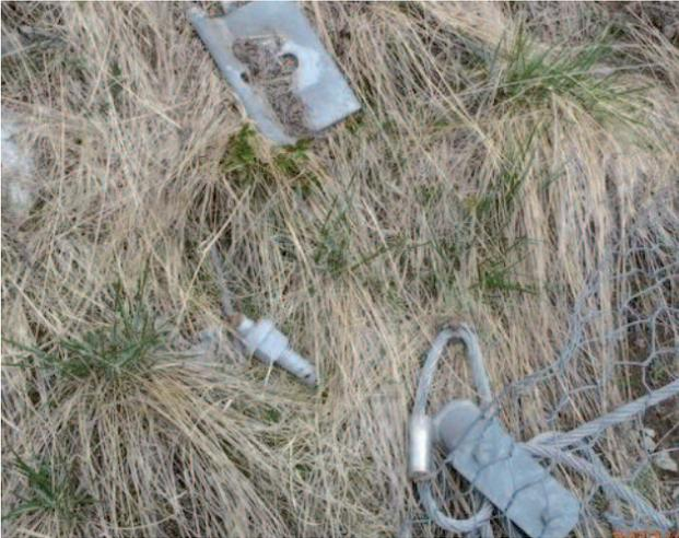
Cliché 33 : Rupture d'ancrage
