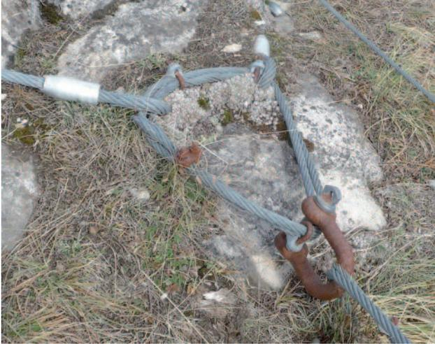
Cliché 47 : Corrosion de différentes pièces
