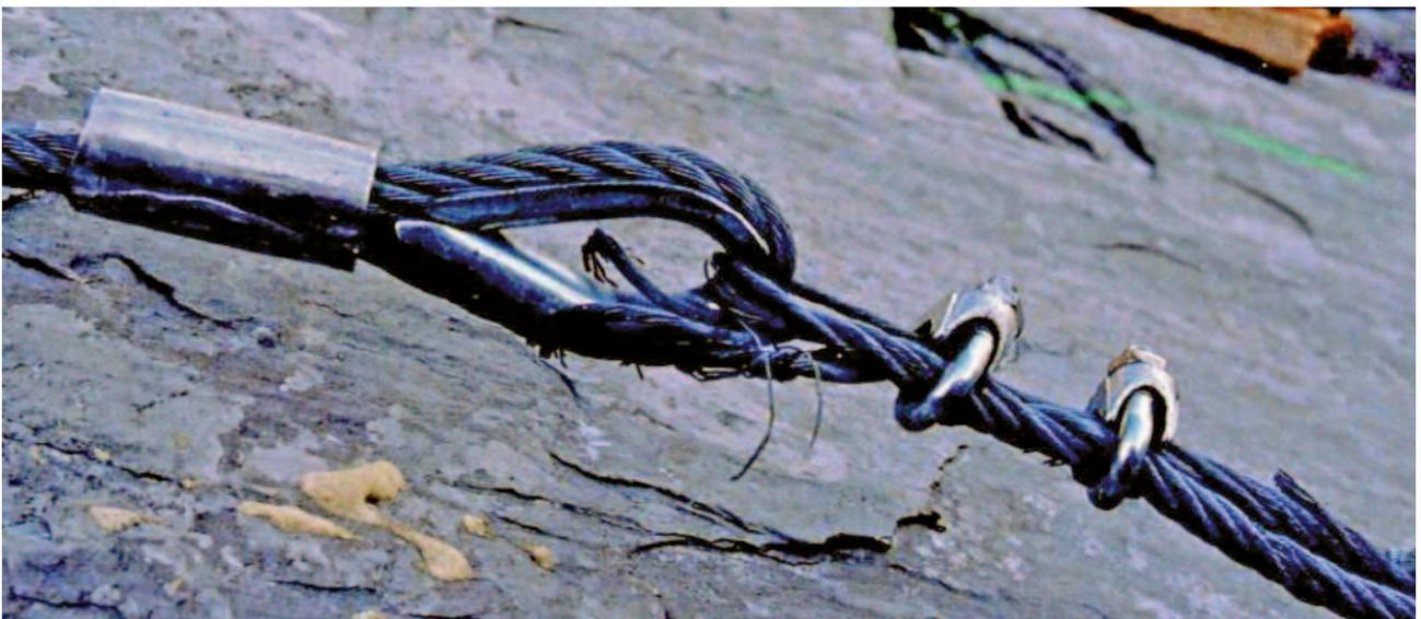
Cliché 35 : Rupture au niveau du câble d'ancrage
