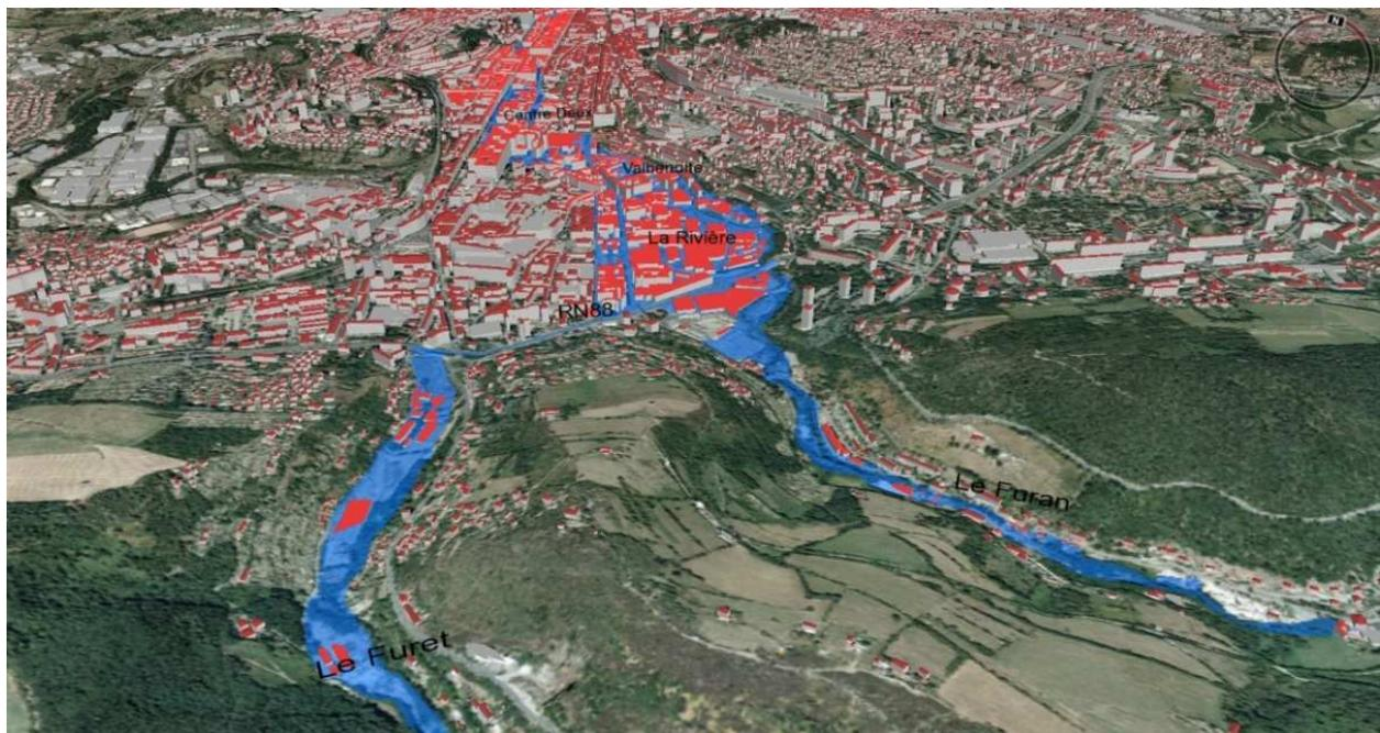
Figure 11 Capture d'écran du modèle numérique de terrain, représentant les débordements prévisibles lors d'une crue centennale du Furan
