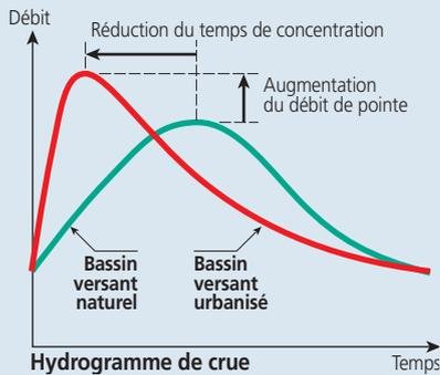
L'**imperméabilisation** du bassin versant occasionne une réduction du temps de concentration et une augmentation du débit de pointe.
