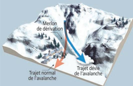
Sécurisation d'un ensemble bâti par l'édification d'un merlon de détournement de l'avalanche.
