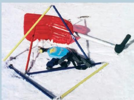
L'appareil de recherche de victimes d'avalanche (ARVA) est un émetteur-récepteur qui permet de repérer plus facilement une personne ensevelie sous une avalanche. Il doit être utilisé avec une sonde pour localiser précisément la victime et une pelle pour la dégager. Ensemble, ils composent la trilogie de sécurité indispensable à toute sortie hors-piste.
