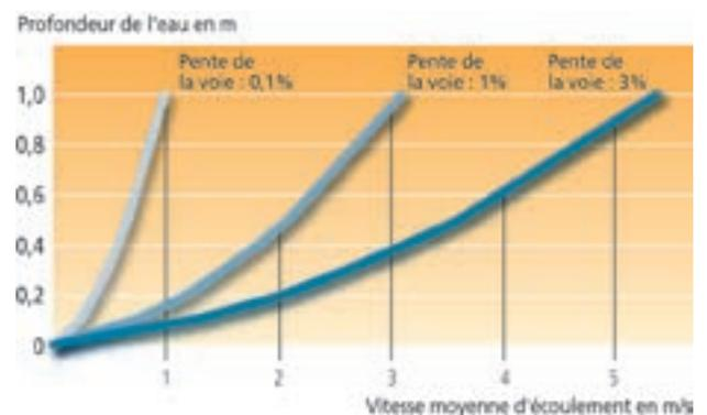
Fig. 7 - Évolution de la vitesse d'écoulement sur une voirie de 10 m de largeur en fonction de la pente et de la profondeur d'eau.
