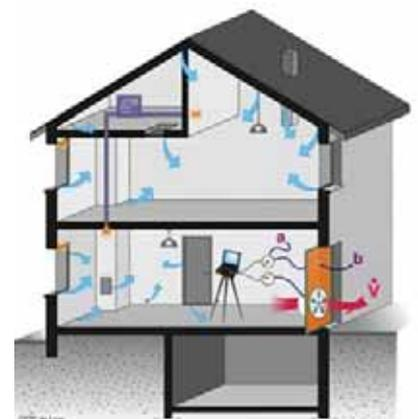
Figure 2 : Mesure du débit de fuite à l'aide d'une fausse porte, source : CETE de Lyon
