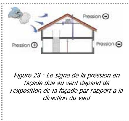
Par ailleurs, la vitesse du vent est généralement corrigée pour prendre en compte les différences entre des données issues de stations météo, c'est-à-dire, généralement en site ouvert et plat, et la vitesse à proximité du bâtiment considéré. Différentes relations existent pour réaliser cette correction. CONFINE propose un choix entre trois types d'entre elles.
