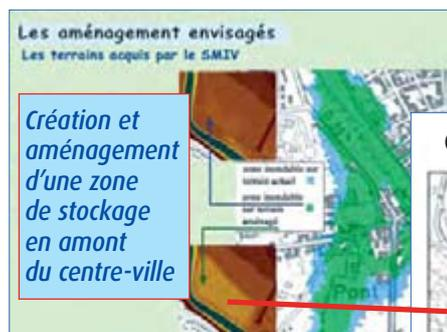
La mise en place d'une zone de stockage, équipée de plantations jouant un rôle de piège anti-embâcle, tend à réduire la zone inondable pour une crue moyenne.
