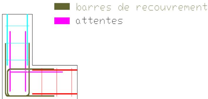
Coffrer le chaînage sur l'ensemble du bâtiment avec une épaisseur de chaînage d'au moins 20cm. Mettre en place le ferrailage (longitudinal et transversal). Veiller au bon recouvrement des armatures longitudinales dans les angles (longueur de recouvrement suffisante, pliage en angle droit dans les angles). Il faut absolument lier le chaînage horizontal au chaînage vertical. Sceller des attentes verticales au droit de celui-ci, et les relier sur le ferrailage horizontal.
