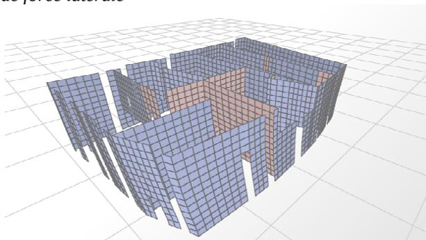
Figure 3-18 : Mode 1 – suivant la direction y
