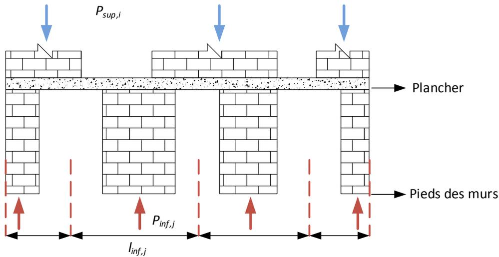
Figure 3-10 : Schéma de descente de charges des murs
