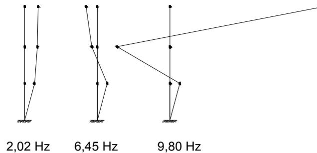
Figure 5-11 : Modes propres de vibration suivant x du bâtiment avec diaphragmes rigides
