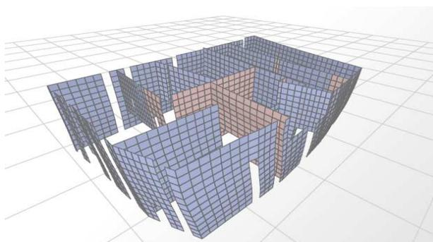
Figure 3-20 : Mode 3 – torsion suivant l'axe z
